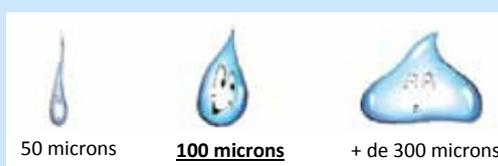
Dans le cas d'un pulvérisateur à jet porté, le diamètre et le nombre de gouttelettes dépendent du volume d'eau, du type de buse et de la pression. Ces paramètres sont donc à prendre en compte dans les choix de matériel et les réglages du pulvérisateur.
