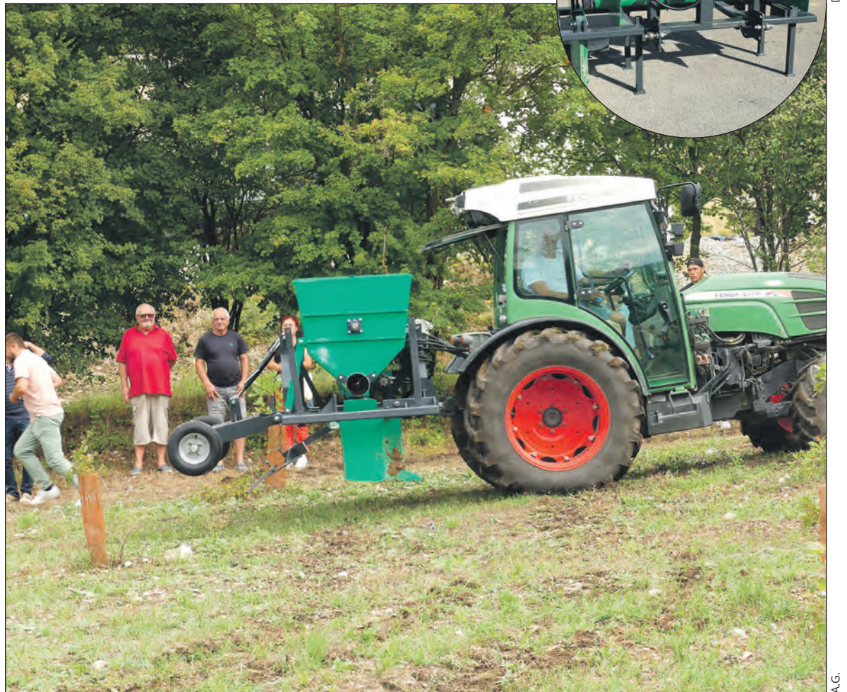
Afin de réaliser des pièges à truffe de manière linéaire, les Pépinières Tenoux ont mis au point un outil spécifique qui existe en deux contenances.
