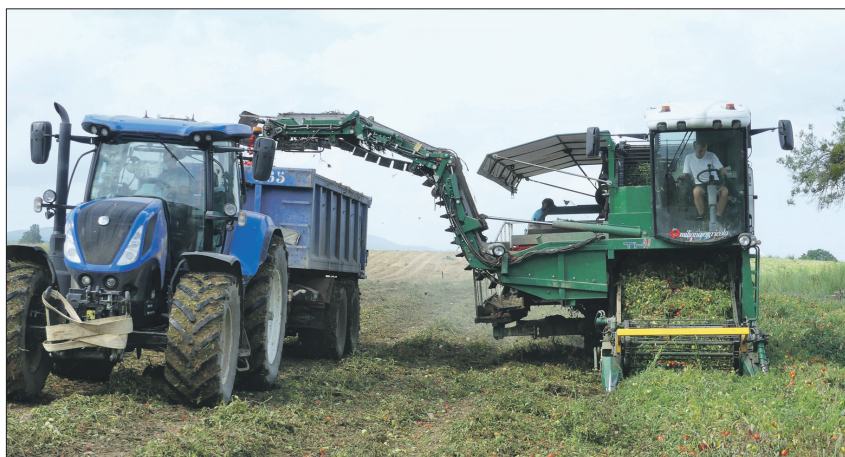
La ramasseuse effectue un tri optique des tomates afin d'éliminer les fruits verts, les pierres et les mottes de terre. Elle peut ramasser deux hectares par jour, soit 16 caissons qui peuvent partir à l'usine.
