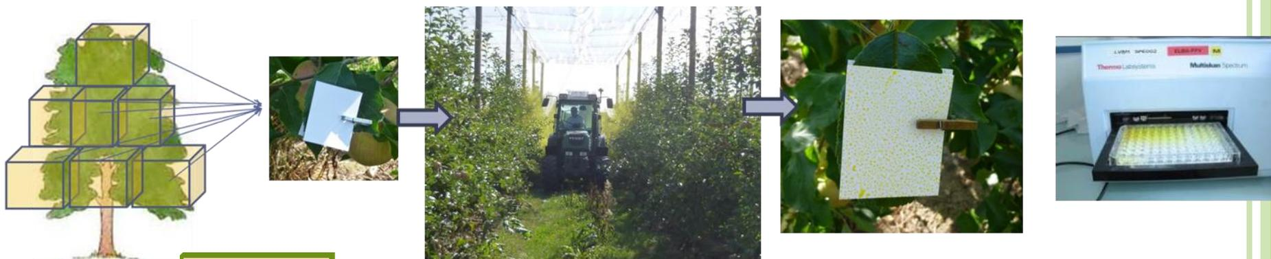
**Mesure des dépôts = quantité de produit déposé par unité de surface de végétal à protéger** (ng de produit/dm<sup>2</sup> de surface foliaire pour 1 g de produit à l'ha), norme ISO 22522, 2007.
