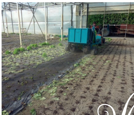
Figure 4 : tests de nettoyage des films en fin de culture de salade avec la dernière version du prototype.
