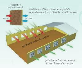
en cellulose ou en plastique, et installés aux entrées d'air. L'air entrant est alors refroidi.
