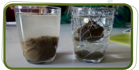
Figure 3 : Slake test, à gauche sol très friable, à droite sol stable
