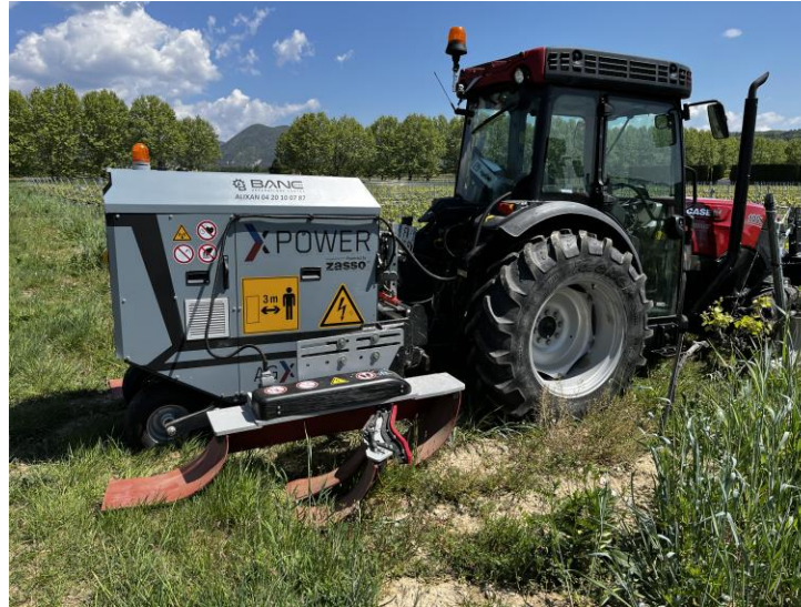
Innovation testée en 2022 : Désherbage électrique XPower de Zasso
