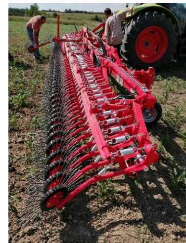
Herse étrille rotative ou roto-étrille
