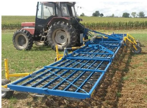
Herse étrille avec ressorts réglables individuels par dent
