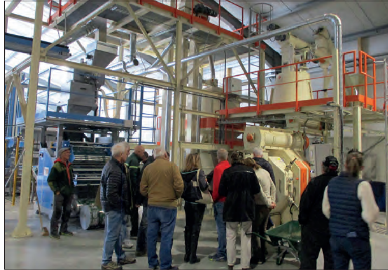
La presse à granulé permet de produire entre 15 et 20 tonnes de pellet par jour.
